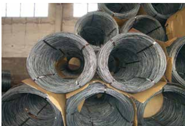
Tråd produsert til bærekablene (Nippon Steel, Japan)
